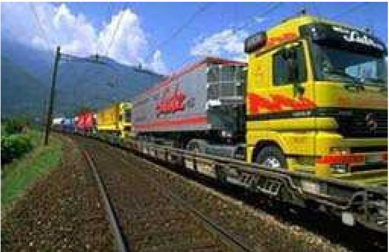
Wagon Talbot surbaissé, en ligne
