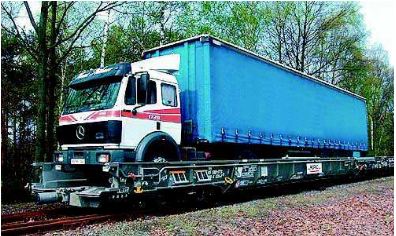
Wagon surbaissé Talbot, équipé d'un bogie à 4 essieux
